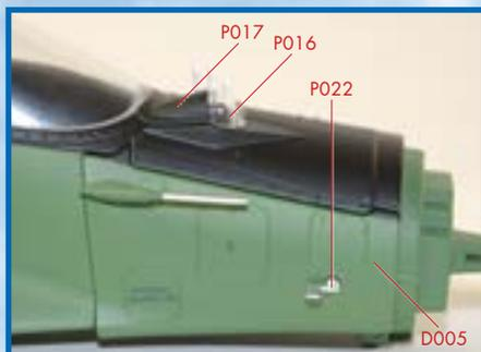
**11** Установите на внешней части кабины прозрачный колпак ОЛС (P016) и кожух ОЛС (P017), как показано на снимке, и зафиксируйте деталь изнутри винтом (AP). Затем установите правую стенку отсека БРЭО (D005) и закрепите ее винтами (CM). Вставьте правый датчик угла атаки (P030) в отверстие на стенке отсека БРЭО.
