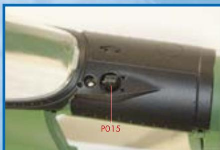
**8** Установите датчик ОЛС (P015) в отверстие верхней обшивки носовой части фюзеляжа, как показано на снимке, и снизу закрепите его винтом (AP).
