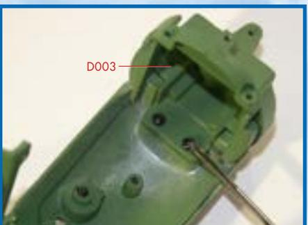
**10** Установите БРЛС с механизмом поворота антенны (D003) на внешней части кабины (D001) и закрепите ее снизу винтами (BM).
