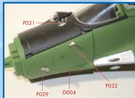
**12** Установите левую стенку переднего отсека БРЭО (D004) и осторожно закрепите ее винтами (CM). Затем вставьте в соответствующие отверстия антенну системы госопознавания (P031), приемник полного давления (P032) и левый датчик угла атаки (P029).
